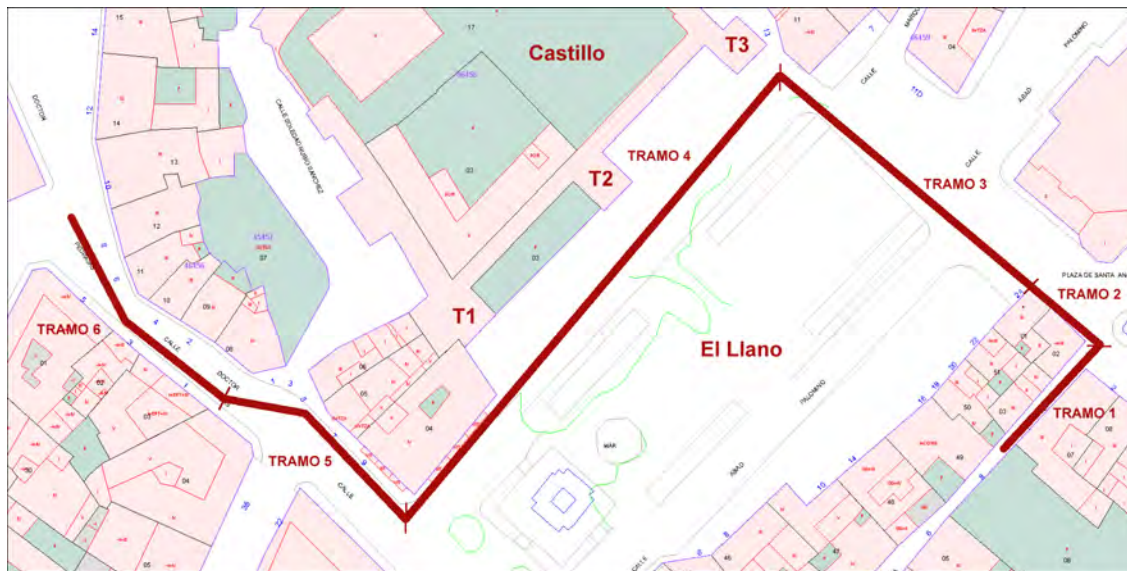
Tramos diferenciados en la zanja para infraestructura de electricidad que comunica la calle Santa Ana con la Plaza de San Pedro
